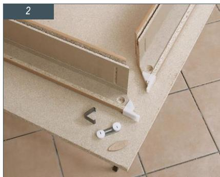
Elementi dovratnika spajaju se čeličnim spajalicama (lijevo) i dvostrukim ekscentričnim spojnicima (sredina) kao i plosnatim tiplama od drva.
